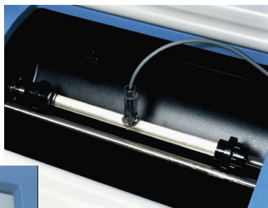
Polarimetro ADP 410 con tubo polarimetrico in posizione
