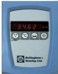
Pannello del polarimetro ADP 410
